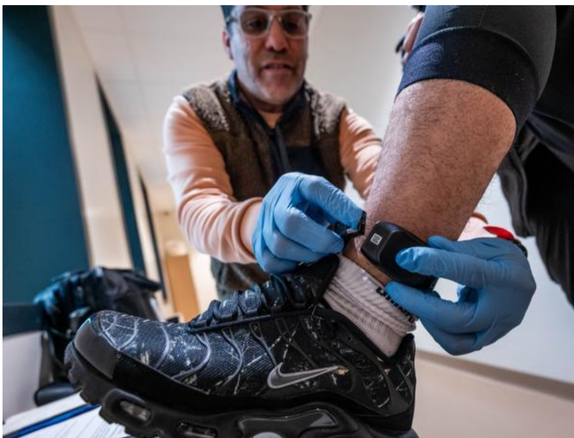
Le bracelet à la cheville du condamné transmet un signal à un ordinateur central via un boîtier installé chez lui.
