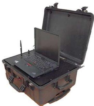
**L'imsi-catchern trompe le GSM, qui le considère comme une antenne-relais, permettant ainsi l'interception d'une communication.**
